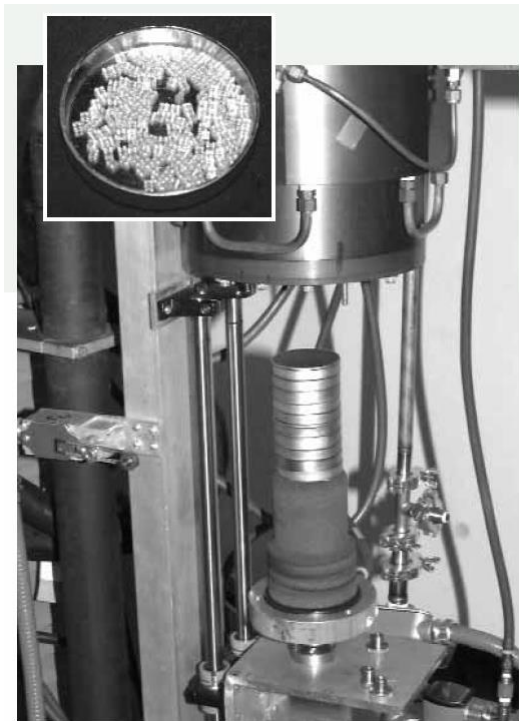
Рисунок 4. Процесс термической обработки. Подносы с брекетами установлены в печь.
